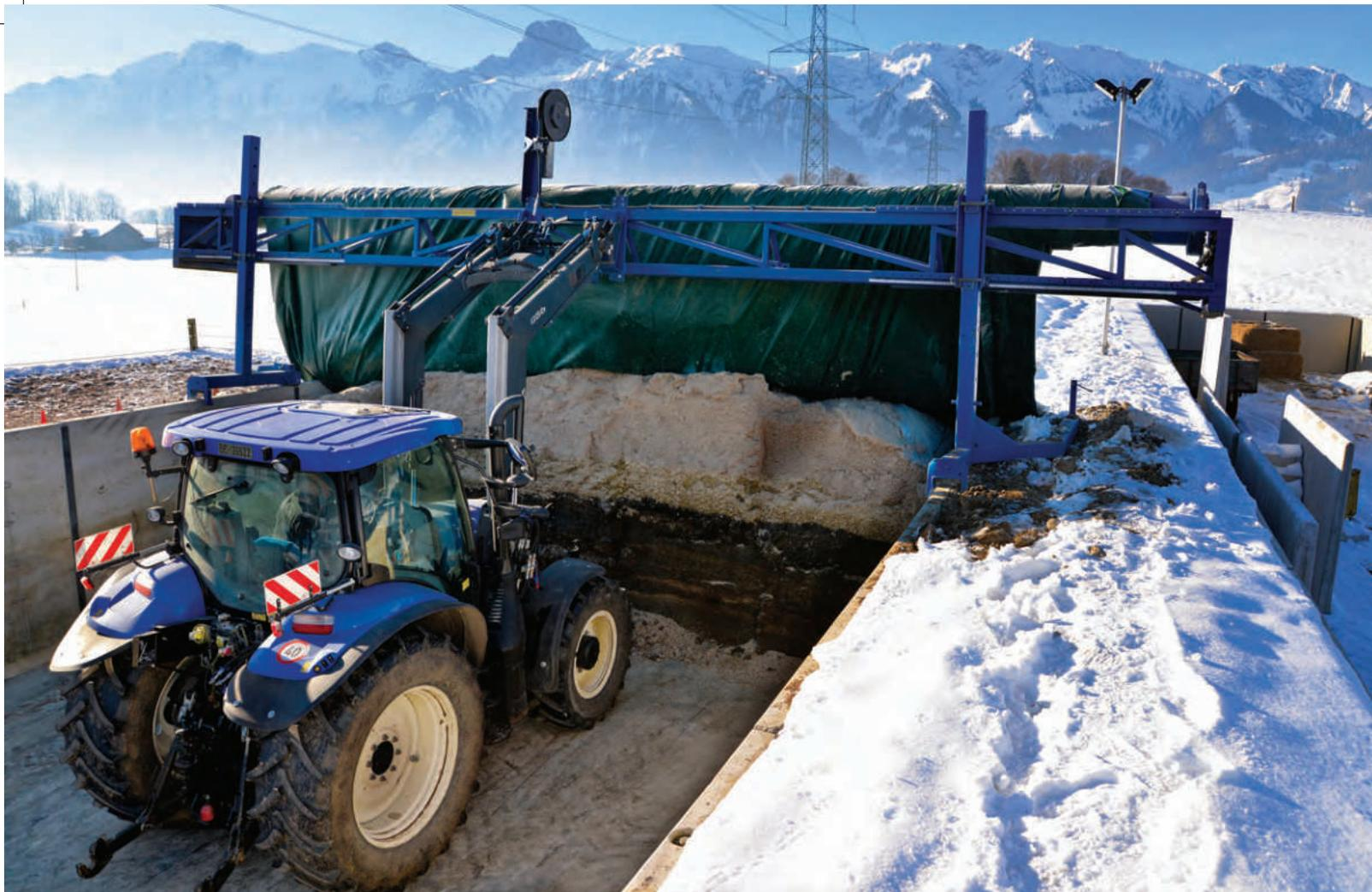
Mit dem Frontlader wird der Haspelträger nach vorne gesetzt und gleichzeitig das Abdecktuch aufgerollt. Als Option gibt es eine Abstützung mit Rollen, die auf der Mauerkrone geführt und beim Aufrollen ohne anzuheben nach vorne gezogen werden.
